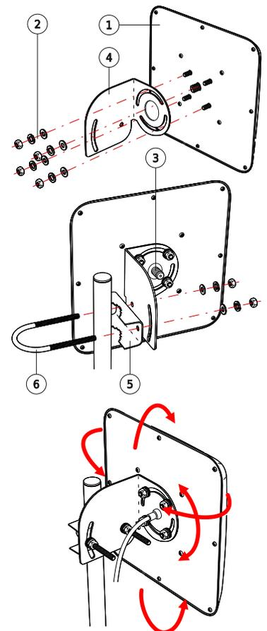
Рисунок 2. Узлы антенны и сборка «FLAT-15F»
