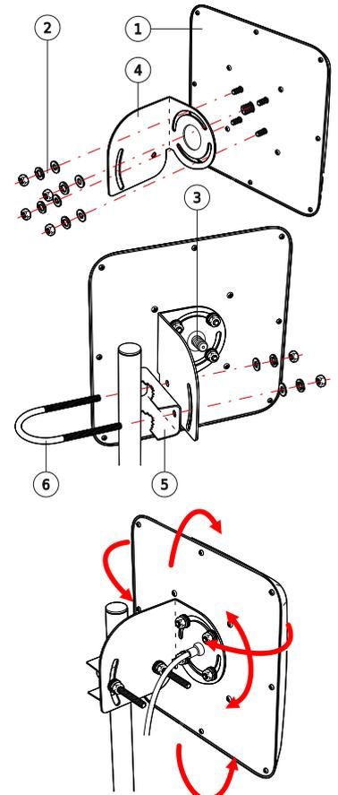
Рисунок 2. Узлы антенны и сборка «FLAT-15F»
